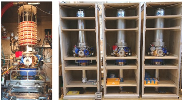
図 1 ITER ジャイロトロン実機。左：2 機目の試験セットアップ、右：1, 3, 4 機目。
