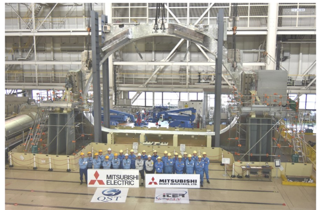
図 1 AU-BU 合わせ完了後の TF コイル 1 号機。
