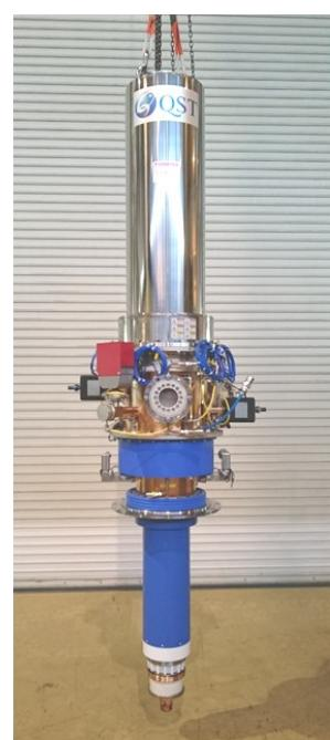
図 2 ジャイロトロン実機：8 機中、2 機分の製作を完了。
