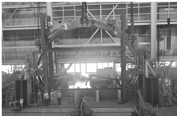
図 1 AU-BU 仮組後の日本向け TF コイル第 1 号機用構造物。
