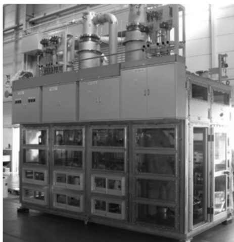
図6 性能確証試験用スクラバ塔システム。
