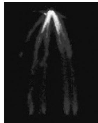
図2 ストリーマ放電の様子。本図の上部に針電極、下部に平板電極とした際の電圧 22 kV 印加時での空气中ストリーマ放電である（文献[2]より引用）。
