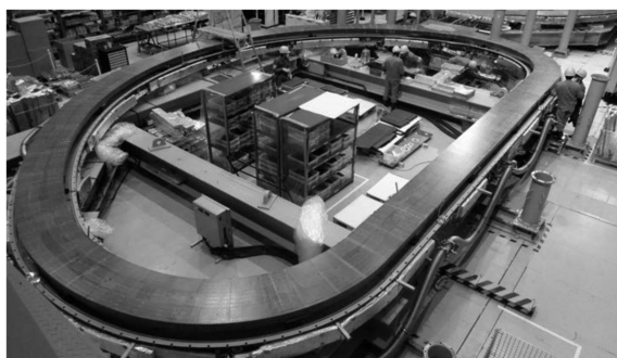
図2 DP含浸を完了したTFコイル第1号機の1体目のDP.
