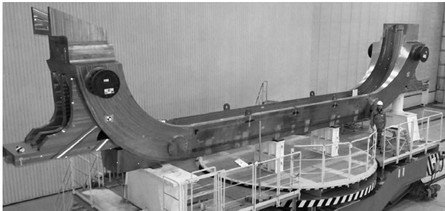
図 1 完成した全長 16.5 m の ITER TF コイルインボード側構造物本体。
