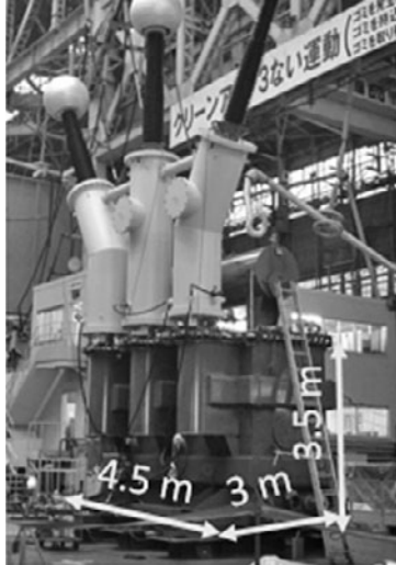
図4 昇圧変圧器の耐電圧試験。
