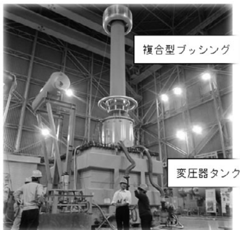
図 3 直流 1 MV 絶縁変圧器試作器。
