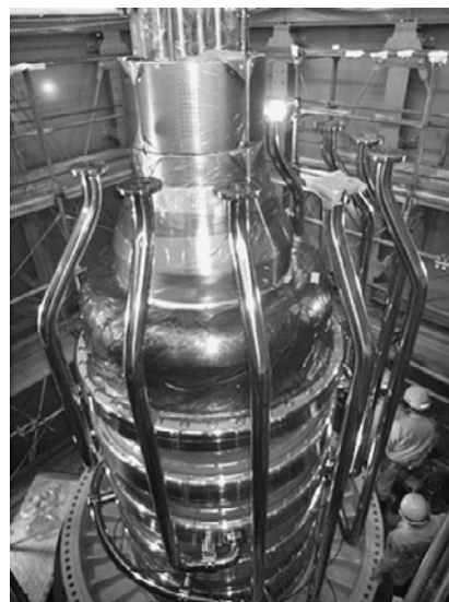
図9 HV ブッシングの外部構造.
