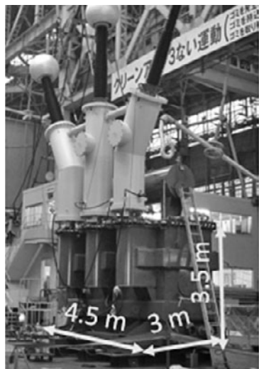
図4 昇圧変圧器の耐電圧試験。
