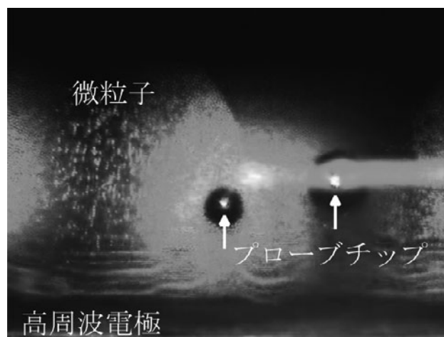
図 5 プラズマ中の微粒子群に挿入されたダブルプローブ。2本のプローブチップはシースで覆われ、微粒子とは接触していない様子がわかる。
