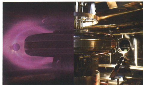
磁気圏型プラズマ装置RT-1のプラズマ 東京大学提供
