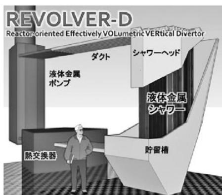
図7 REVOLVER-D ユニット概念図。
