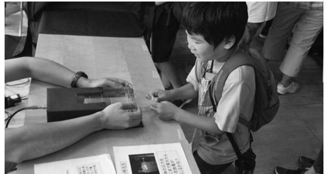
写真5 注射器型火花放電装置。自分の腕力でピストン内の圧力を下げ、数kVの電極間にプラズマを作ります。
