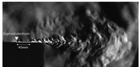
図3 シュリーレン法による誘起流れ場の可視化。
