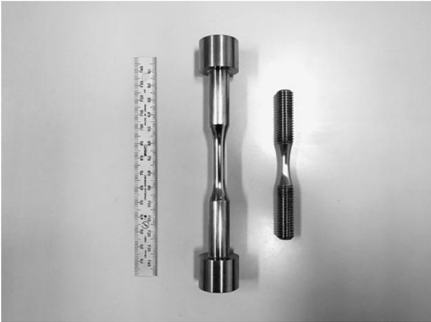
図5 疲労試験片の外観写真。
