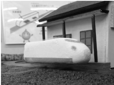
図2 超伝導磁気浮上列車（永久磁石の線路の上を、高温超伝導体を積んだ列車が浮上して走る）。
