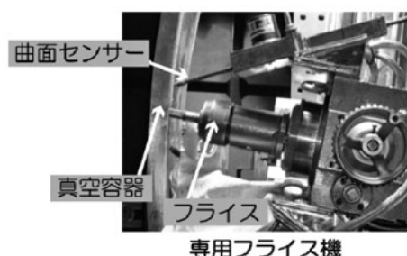
図 6 真空容器専用のフライス加工機。
