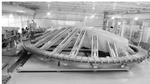
図3 製作を完了した実機 TF コイル用の巻線。
