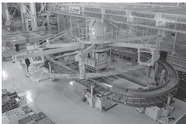
図5 検証試験中のトランスファ装置。
