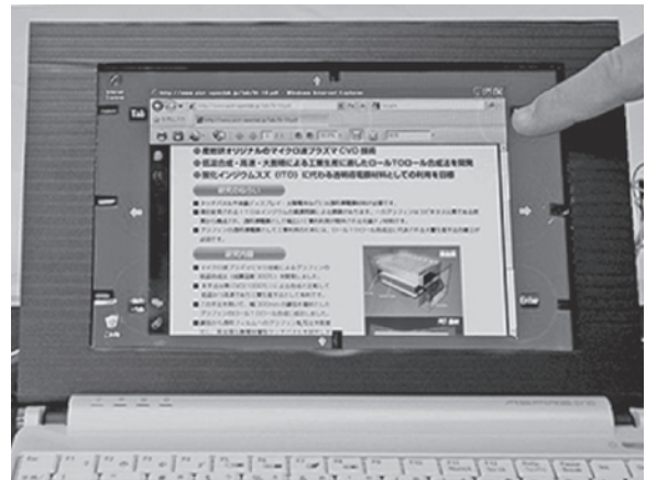
図14 マイクロ波プラズマCVDで作製したグラフェン透明電極タッチパネルを装備したノートパソコン。
