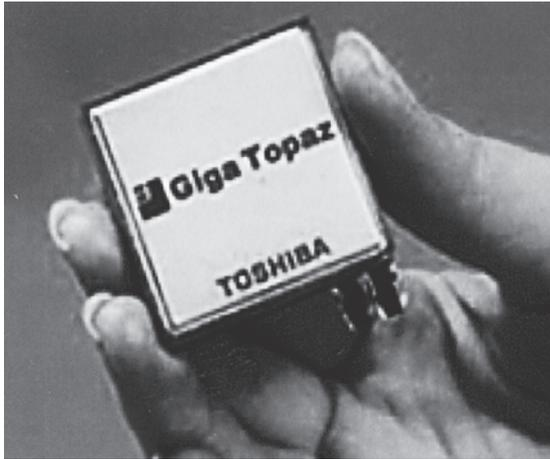
図4 TEG モジュールの一例：2004年に東芝が発表した[Giga Topaz™]，出力密度 1 W/cm<sup>2</sup>。
