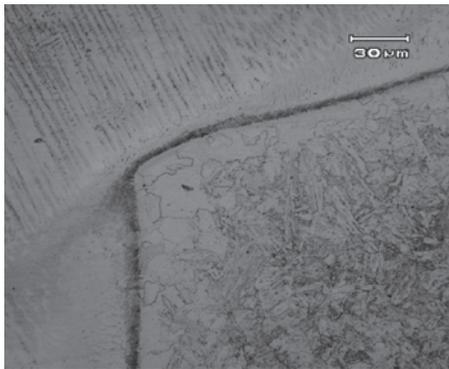
図9 309系溶接材をインサート材として用いたF82H-SUS316L異材TIG溶接 F82H-309界面近傍 (左上: SUS309側, 右下: F82H側)。
