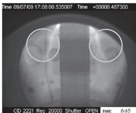
図16 STプラズマ形成時の画像。丸で示した部分から環状プラズマが形成されている。
