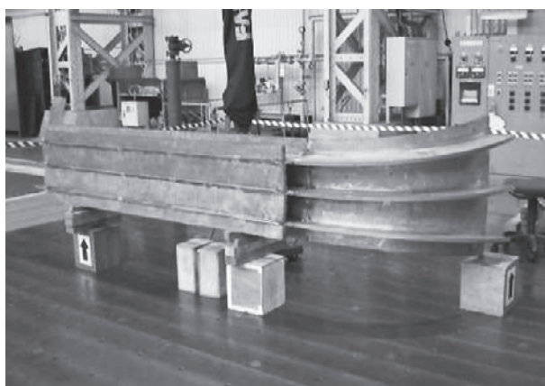
図2 試作した真空容器 20 度上半部のインボード直線部と曲線部の接続(左)、10 度セグメント 2 個を接合した 20 度アウトボード(右)。
