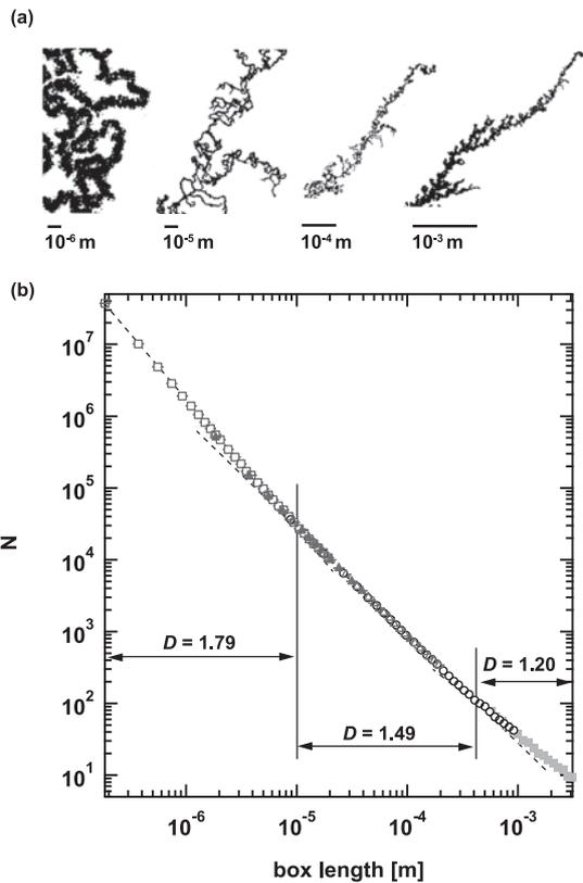
図14 ナノスケールの繊維状タングステン層に単極電極から放電を発生させた場合のアークの軌跡およびそのフラクタル解析の結果[16, 17].
