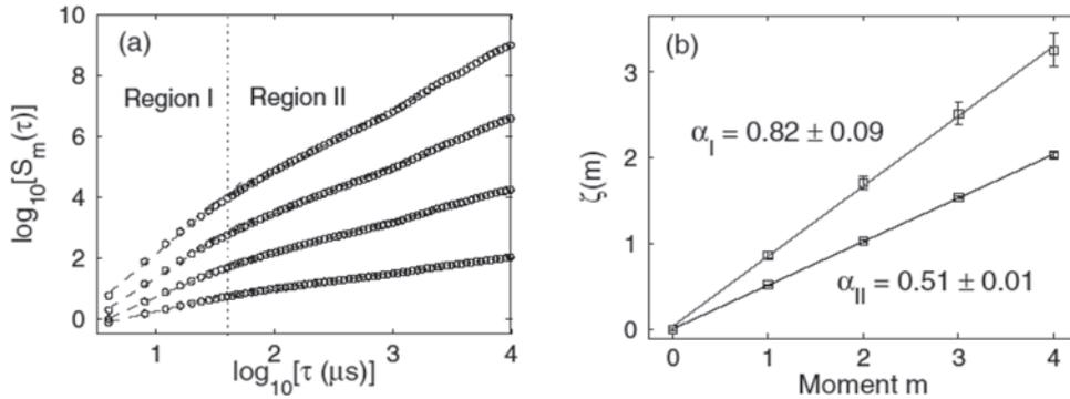
図12 (a)LHDで計測されたイオン飽和電流から構造関数を計算した一例 ( $n=2$ の場合)。2つの領域でべき指数が異なっている。(b)各領域におけるべき指数の値をモーメントの次数に対してプロットした結果[13]。
