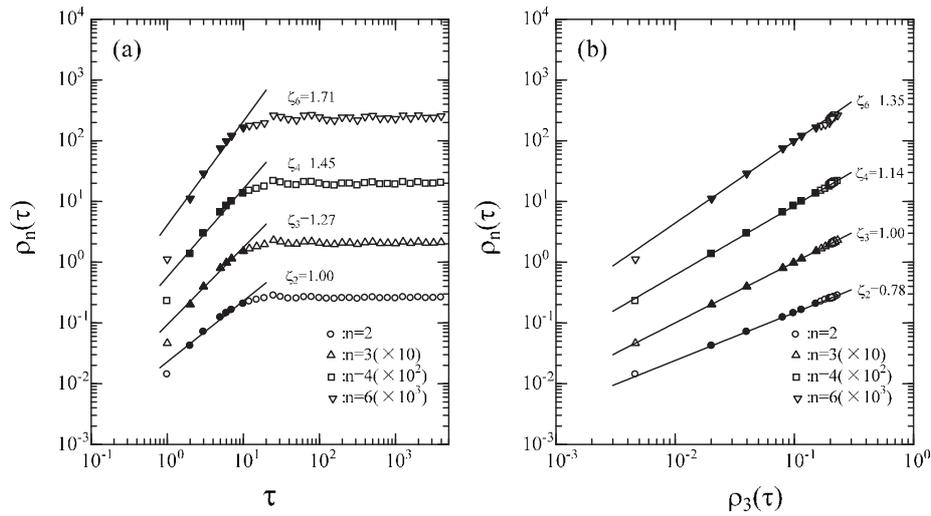
図10 (a) プラズマ中心 ( $r=0$ ) における密度変動のデータを用いて計算された構造関数. グラフが重ならないように縦軸方向に移動させてある. (b) 同一データを ESS によりプロットした場合.
