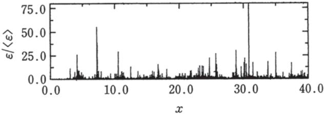
図7 大気乱流中で計測された1次元エネルギー散逸率の分布. 縦軸は平均値で無次元化してある.
