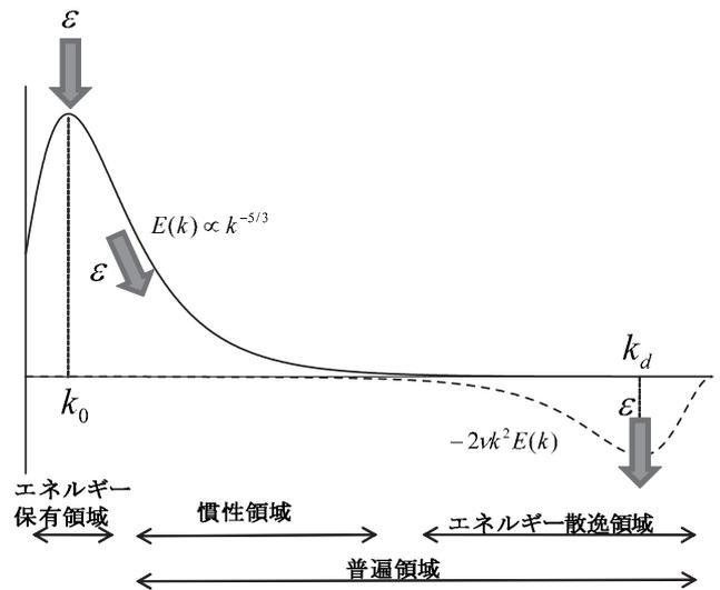
図 2 エネルギースペクトル  $E(k)$  とエネルギー散逸スペクトル  $2\nu k^2 E(k)$ . 外部から注入されたエネルギーは、慣性領域をとおり散逸領域まで運ばれて、粘性により熱エネルギーとなって流体系からでていく。
