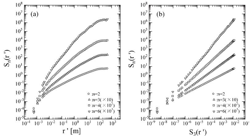
図3 (a)レイノルズ数の大きな大気乱流中で計測された速度信号を用いて計算された速度構造関数。グラフが重ならないように縦軸方向に移動してある。(b)  $n$  次の速度構造関数を3次の構造関数に対してプロットした場合 (ESS5.1を参照のこと)。
