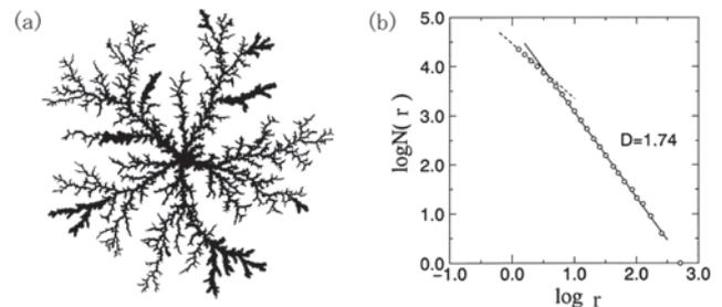
図6 (a) 狭い隙間内の高粘性流体を粘性の低い流体で置換した場合にできる構造 (粘性指状体), (b) 右図の指状体をボックスカウンティングで解析した結果. ベキ指数はフラクタル次元  $D^{(2)}$  に相当する.
