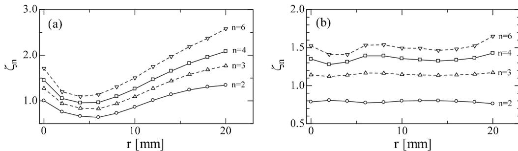
図11 プラズマ密度変動の構造関数におけるベキ指数半径方向への変化. (a) 構造関数から直接求まる場合, (b) ESS を用いた場合.
