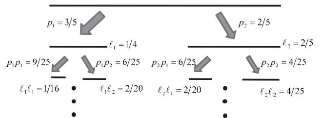
図8 初期条件として, 長さ1の線分に一様な確率がのった場合を考える. 長さを1/4と2/5に分割して, 確率を3/5と2/5に分ける操作を繰り返す. 十分な回数操作をくりかえすと, 間欠的に分布する点の集合が構成され, その点には高い確率から低い確率までがのった分布が構成される.
