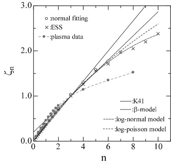
図4 速度構造関数のベキ指数  $n$  に対する変化。間欠性を取り入れたモデルとの比較。ESSを用いた流体乱流(×印)とプラズマ乱流(●印)との比較。
