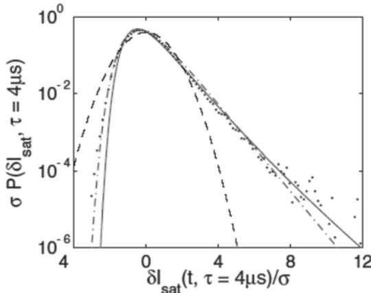
図13 LHDで計測されたイオン飽和電流の領域I (図12参照)における確率密度関数[13]。波線はガウス分布、実線は式(21)、式(22)によって最小二乗フィットさせた結果。
