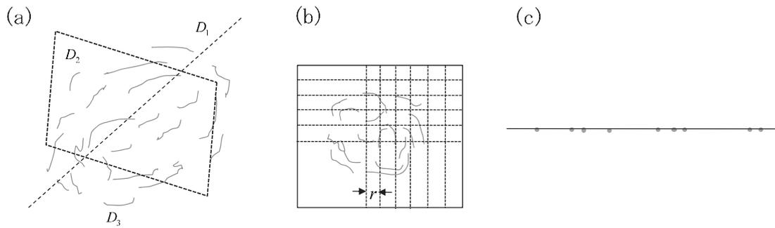
図5 (a) 流体界面の3次元的な模式図 (フラクタル次元  $D^{(3)}$ ). (b) 平面との交わり (フラクタル次元  $D^{(2)}$ ), (c) 直線との交わり (フラクタル次元  $D^{(1)}$ ) によってできる図形.
