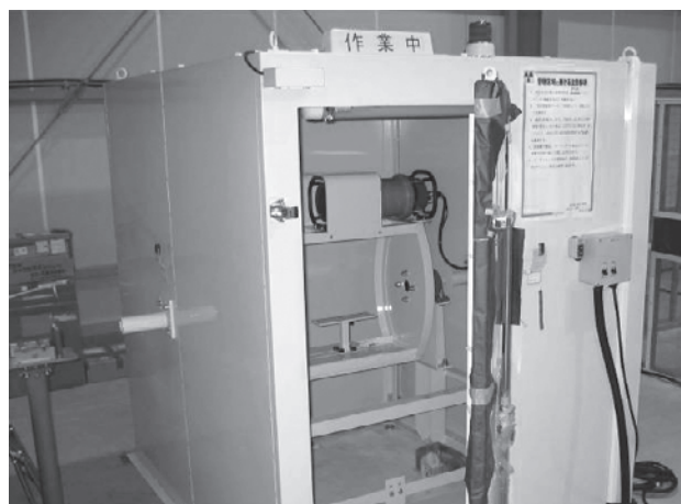
図2 超伝導導体製作棟に設置されたX線透過検査装置。
