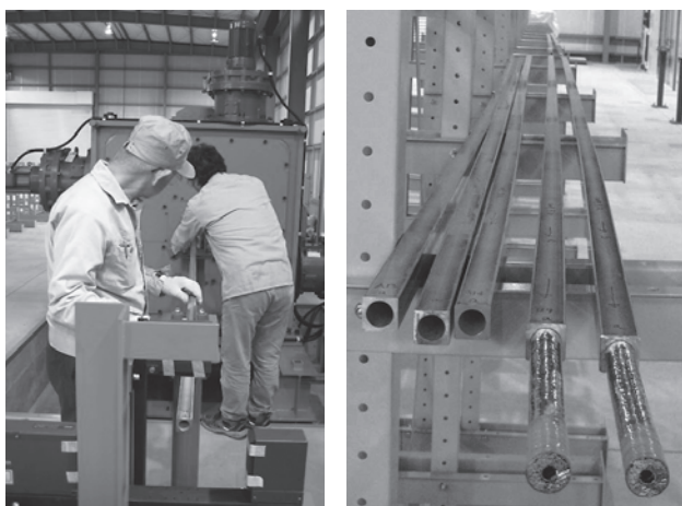
図1 コンパクション装置の動作試験と製作した銅ダミー導体。
