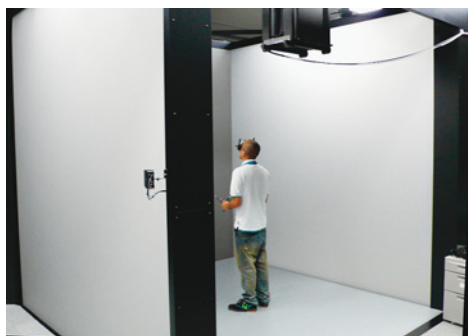
図1 標準的なCAVE装置の外観。3つの壁面と床面と立体画像が投影されるスクリーンになっている。これは地球シミュレータセンターのCAVE装置「BRAVE」の写真である。
