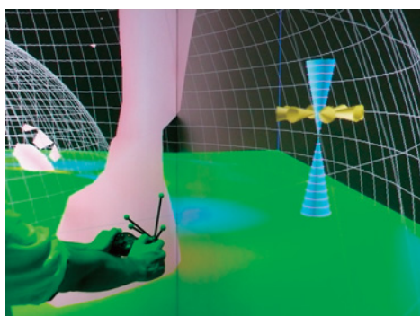
図7 VFIVEの等値面表示機能“Isosurface”. ピンク色の物体は地球ダイナモシミュレーションで得られた対流の渦度場のある成分の等値面である。この図の右の方に浮かんでいる青色と黄色の円錐(の集合)物体は、等値面のレベルをコントロールするためのユーザーインターフェースである。ワンドを上下に動かすと、黄色の物体がそれに従って上下する。その高さが等値面のレベルを決める。
