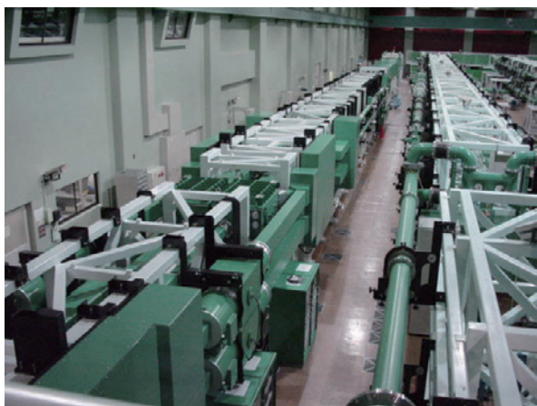
図4 FIREX-Iプロジェクトでの爆縮プラズマの加熱のためのLFEXレーザーが完成（2008）
