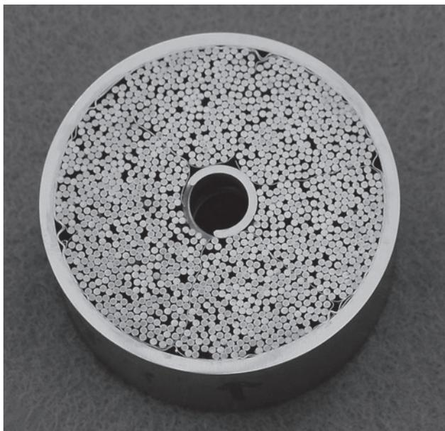
写真 日本で試作された ITER-TF コイル用導体サンプルの断面 (Sultan 試験設備において性能試験が行われた) 導体直径: 約 43 mm, Nb<sub>3</sub>Sn 超伝導素線: 900本, 銅素線: 522本。
