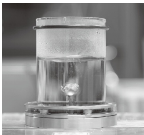
図16 27.12 MHzの高周波を用いた大気圧水中プラズマの発生。反応容器は石英ガラスであり、大きさは内径55 mm、高さ83 mmである。
