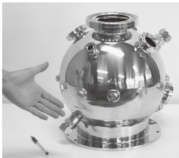
図16 地雷探査用超小型水冷 IECF チャンバー (内径: 20 cm $\phi$ , 外径: 30 cm $\phi$ )。
