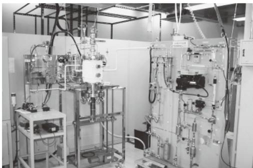
図2 白い部分(約2リッター)がマグネシウム反応装置。右は水素測定部。
