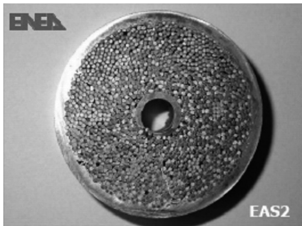
写真1 Sultan試験設備での性能試験に供されたITERトロイダル磁場コイル用導体サンプルの断面（直径約40mm）（ITER機構提供）。
