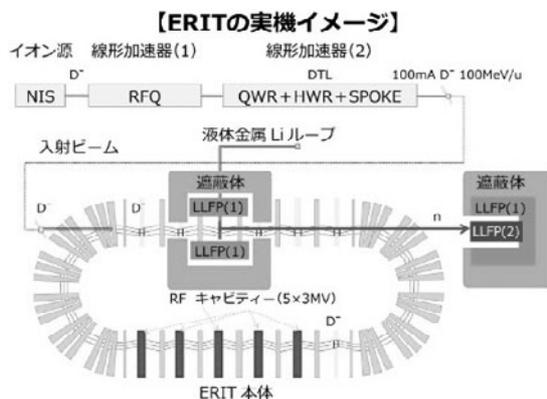
図4 ERIT (Energy/Recovery Internal Target) を用いた核変換システムのイメージ図. ([https://www.jst.go.jp/impact/hp\\_fjt/outline/project/index.html#project-04](https://www.jst.go.jp/impact/hp_fjt/outline/project/index.html#project-04))
